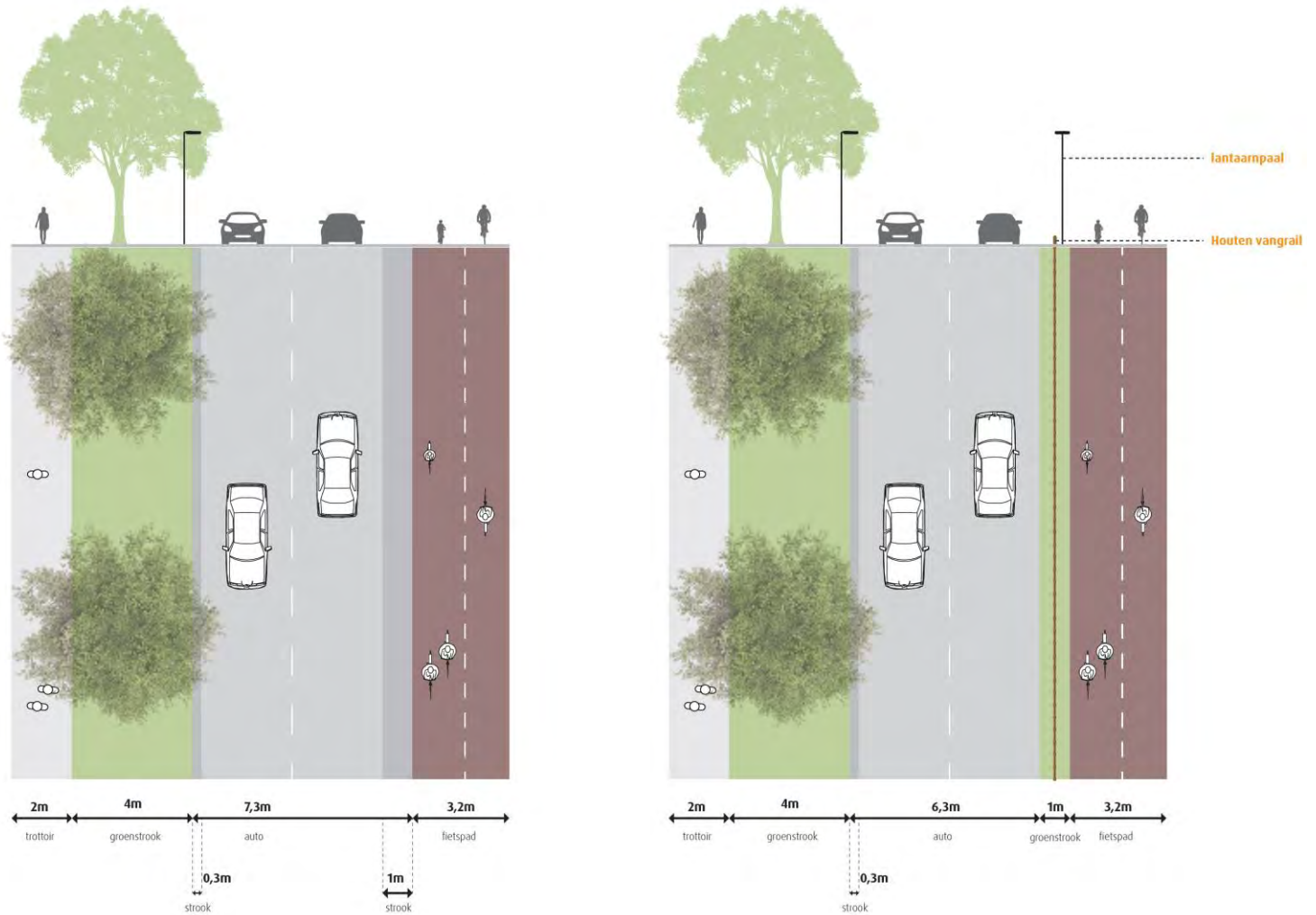
Figuur 4.6: Profielschets huidige situatie (links) en voorgestelde toepassing houten afscheiding (rechts).
