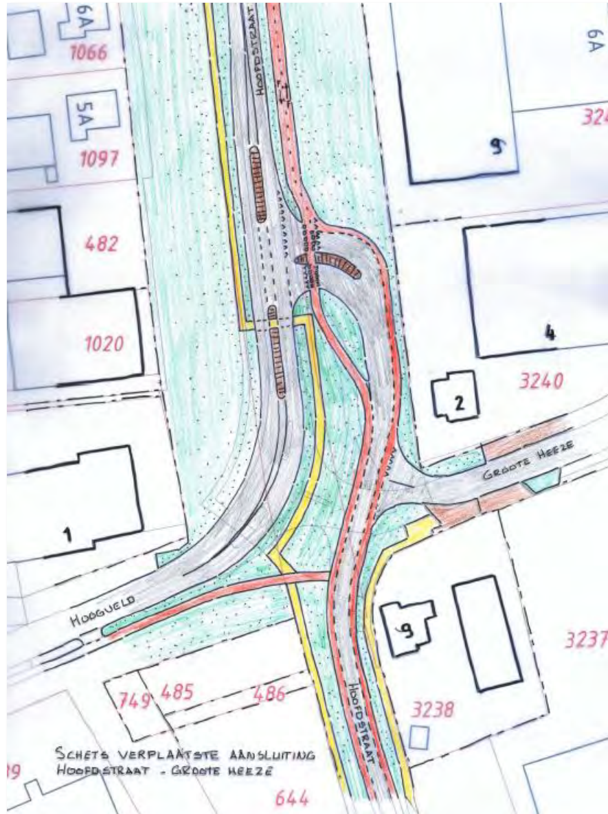
Figuur 3.8: Schets vormgevingsvariant 7: Verplaatste aansluiting.
