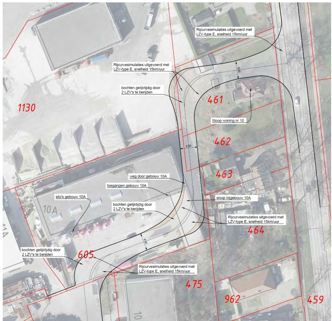
Figuur 4.2: Verkeerskundig ontwerp variant 3; doorsteek via MPG Mortel en aansluiting tussen Hoofdstraat 8 en 10.
