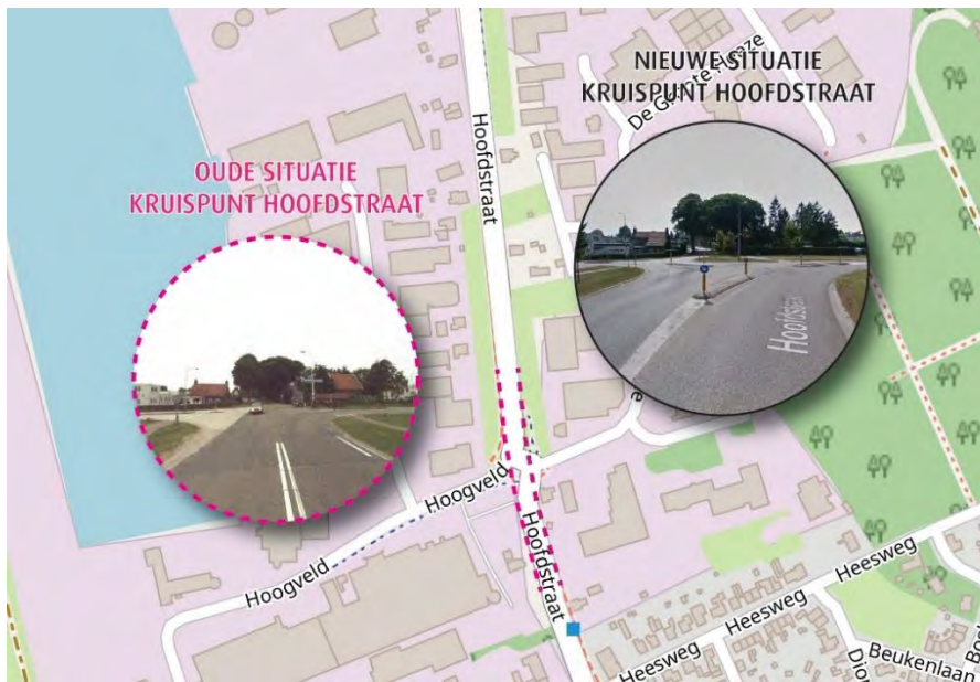
Figuur 4.1: Voormalige en huidige verkeerssituatie kruispunt Hoofdstraat – Hoogveld – De Grote Heeze (in plattegrond is de 'oude' situatie indicatief weergegeven met de rode stippellijn).
